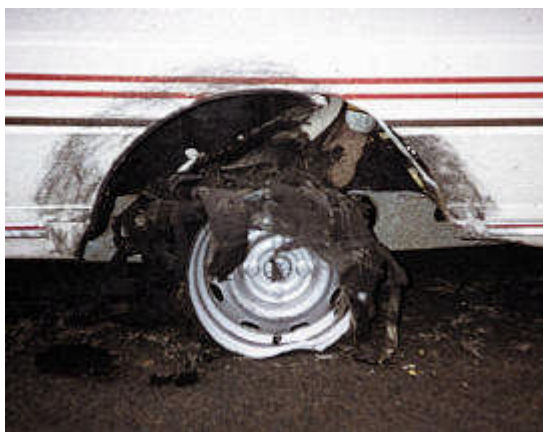
Abbildung 3: beschädigter Radkasten durch einen Platzreifen
